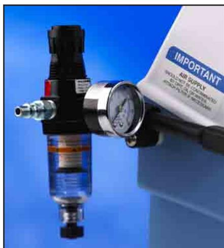
pression du filtre à air du **Thermo-Seal Y151** ne doit pas être en dessous de 70 P.S.I. ou de 5 barres. Ceci n'est pas le dernier réglage de pression à effectuer pour le régulateur de la pression du filtre à air du **Thermo-Seal Y151**.
