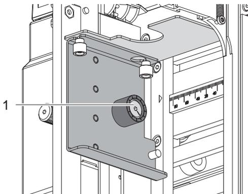
Figure 12 Réglage du frein de déplacement
