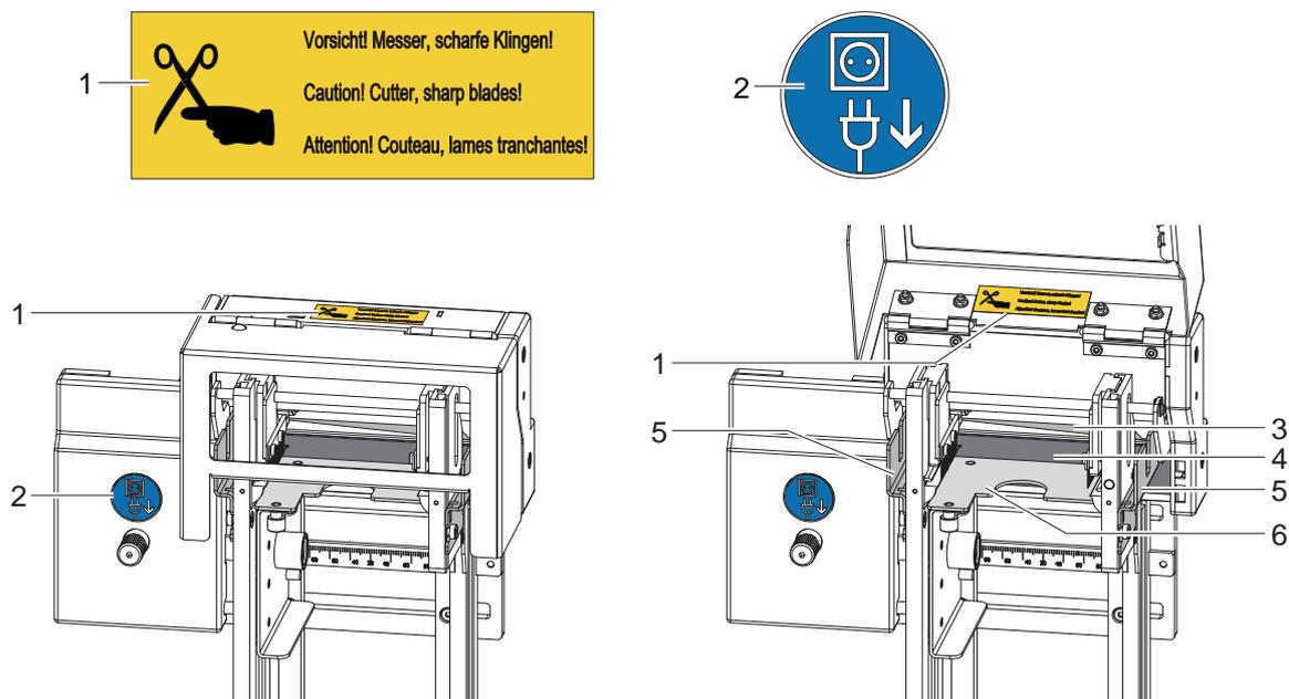
Figure 1 Équipement de sécurité, signalisation de sécurité
