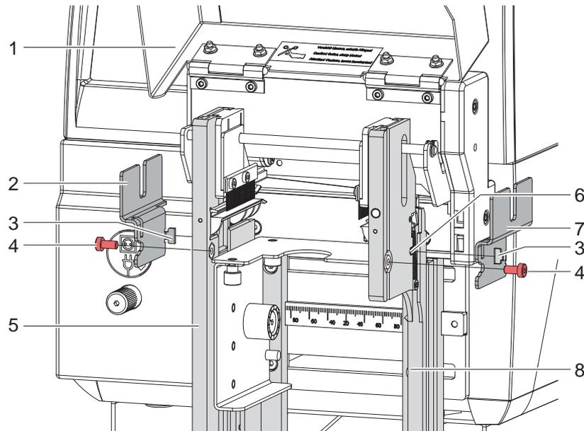
Figure 9 Montage des protections
