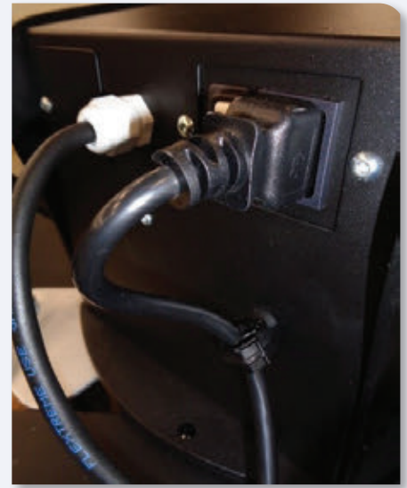
Das Netzkabel ist sicher montiert
