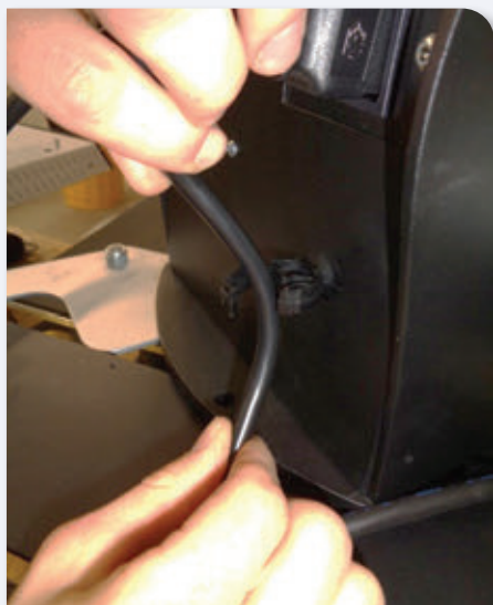
Breng het snoer aan de voorkant van de klem aan
