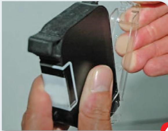
Heben Sie den Riegel vorsichtig an, bis sich der Patronenclip von der Tintenpatrone löst (siehe Abbildung 4)
